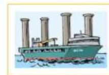
f) Bateau à cylindre propulsé par l'action du vent
