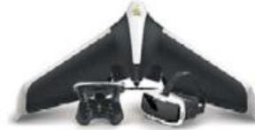
b) Drone programmable avec vision immersive et microcontrôleur pour stabiliser le vol.
